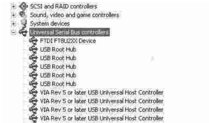
Figura 3: captura din Device manager in care se vede driverul pentru circuitul FTDI
